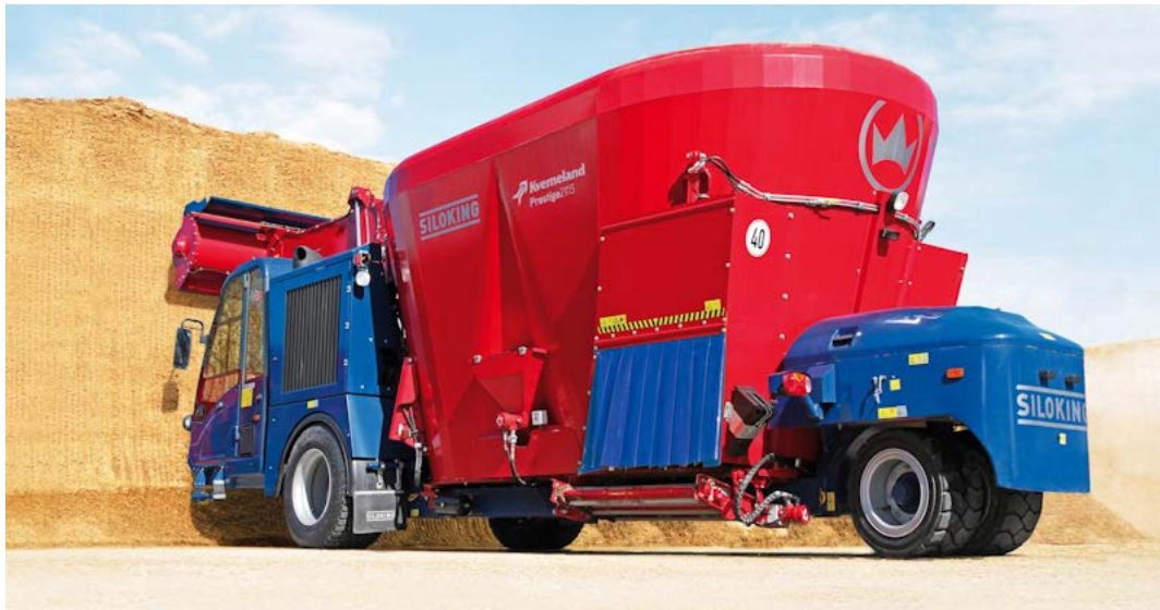
Carro Prestige 2115 SCR – 18m 3 , 2 coclee e un motore a 6 cilindri da 129kW/175cv
